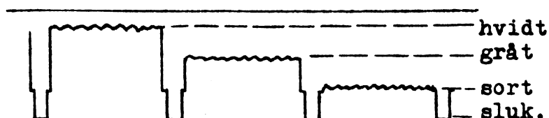
Fig. 5.05 Billedimpulser for forskel- lige intensiteter på bil- ledskærmen, målt direkte efter VF-detektoren.
